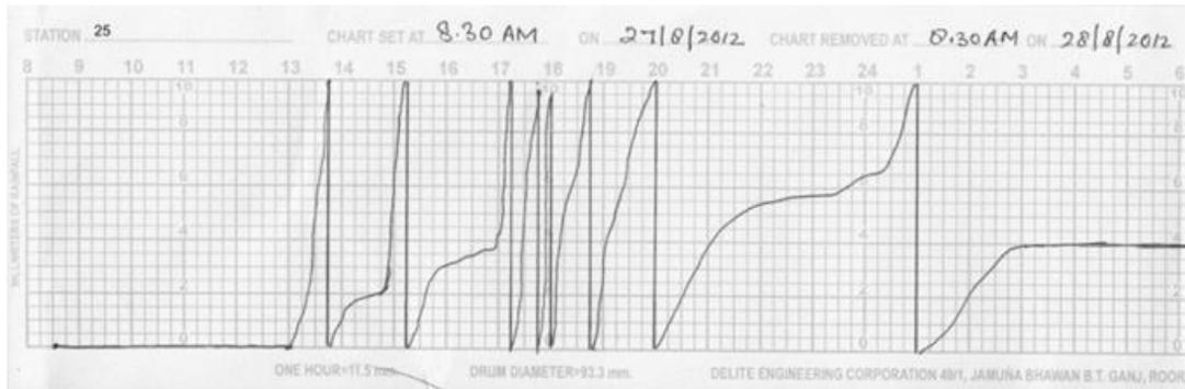
**Figura 2.16:** Gráfico do pluviômetro de sifão natural. Fonte: (Ahmad et al., 2017).
