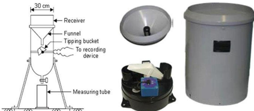
**Figura 2.12:** pluviômetro de registo de precipitação. Fonte: (Ahmad et al., 2017).
