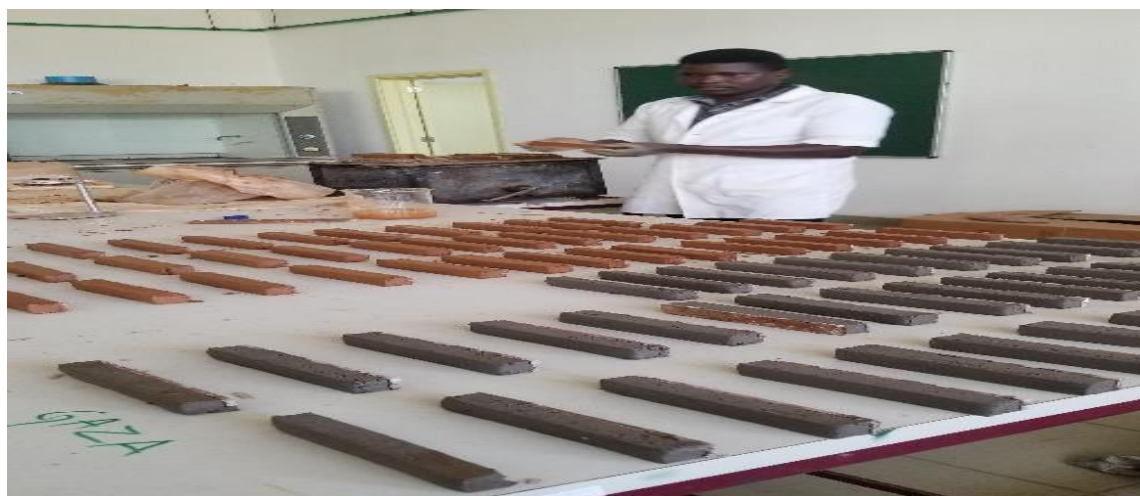
Figura 7: Produção e moldagem de provetes de argila para ensaios físico-mecânicos e térmicos realizados no laboratório de caracterização de materiais.
