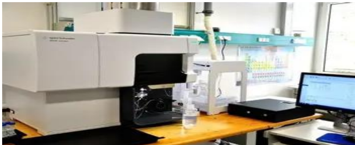
Figura 9: Determinação de metais pesados por espectrometria de emissão atômica por plasma acoplado indutivamente
