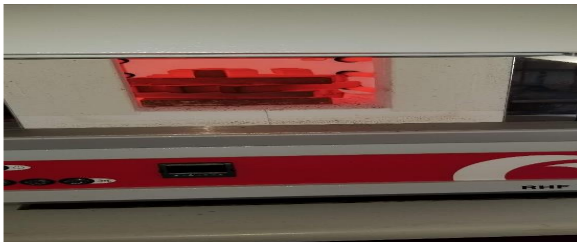
Figura 8: Ensaio de queima dos provetes
