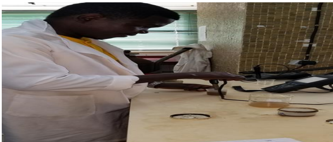
Figura 6: Determinação do pH em suspensão de argila durante a caracterização físico-química
