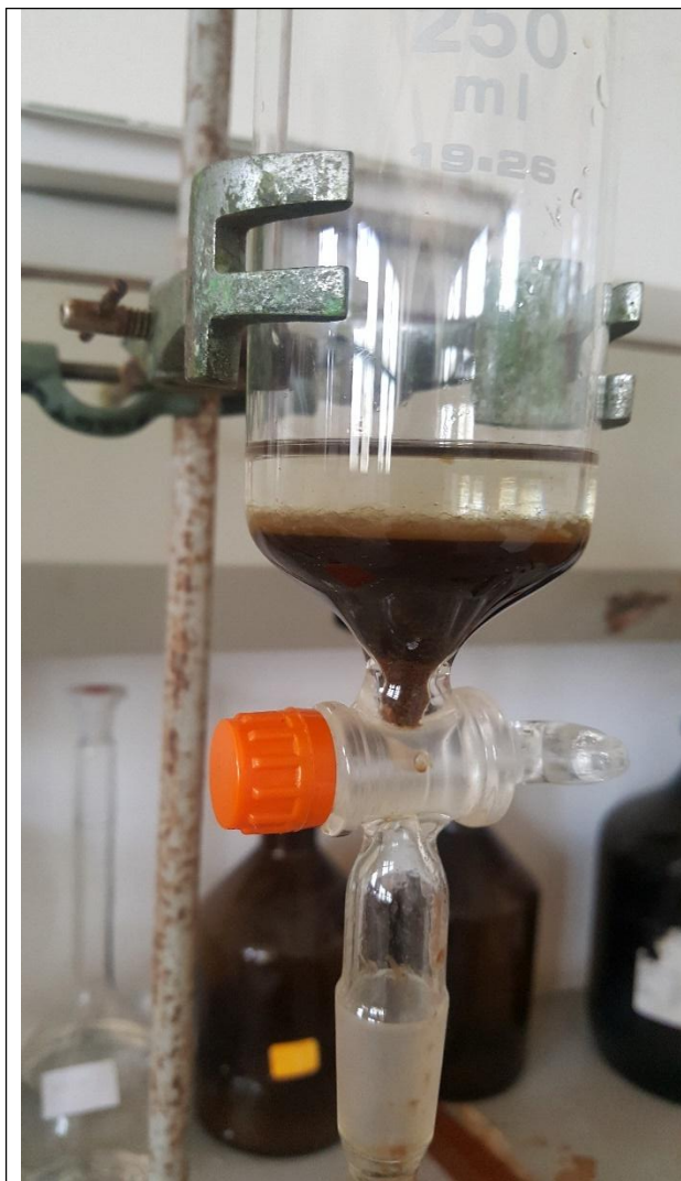
Imagem E - Separação líquido - líquido do extracto bruto alcoólico das sementes
