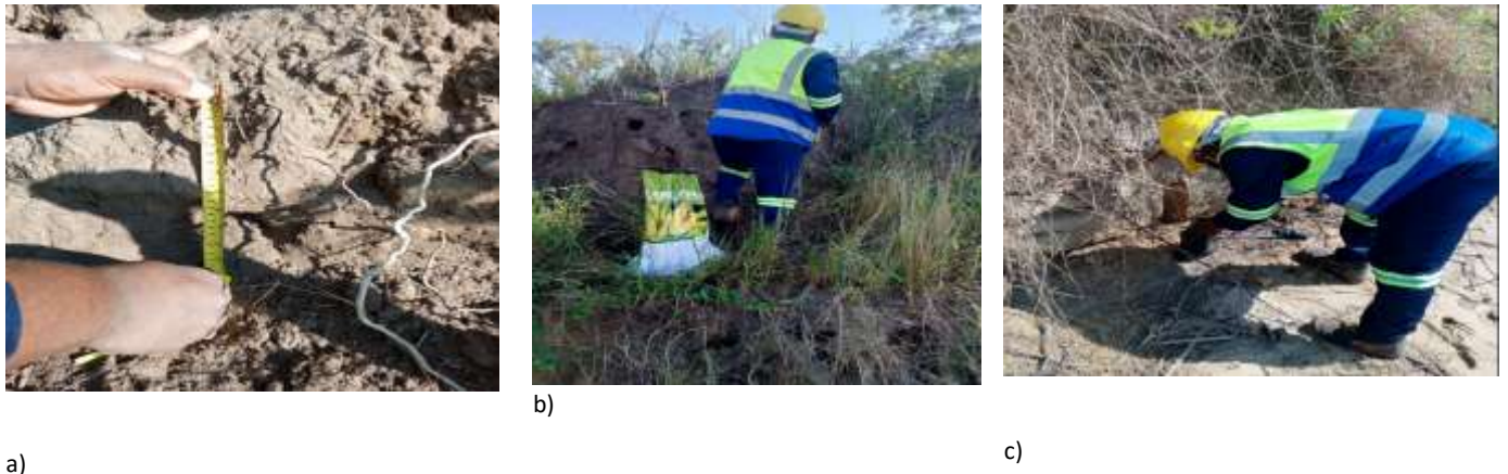
Figura 17. Coleta de amostra de sedimentos: a) medição da coluna; b, c) retirada da amostra;
