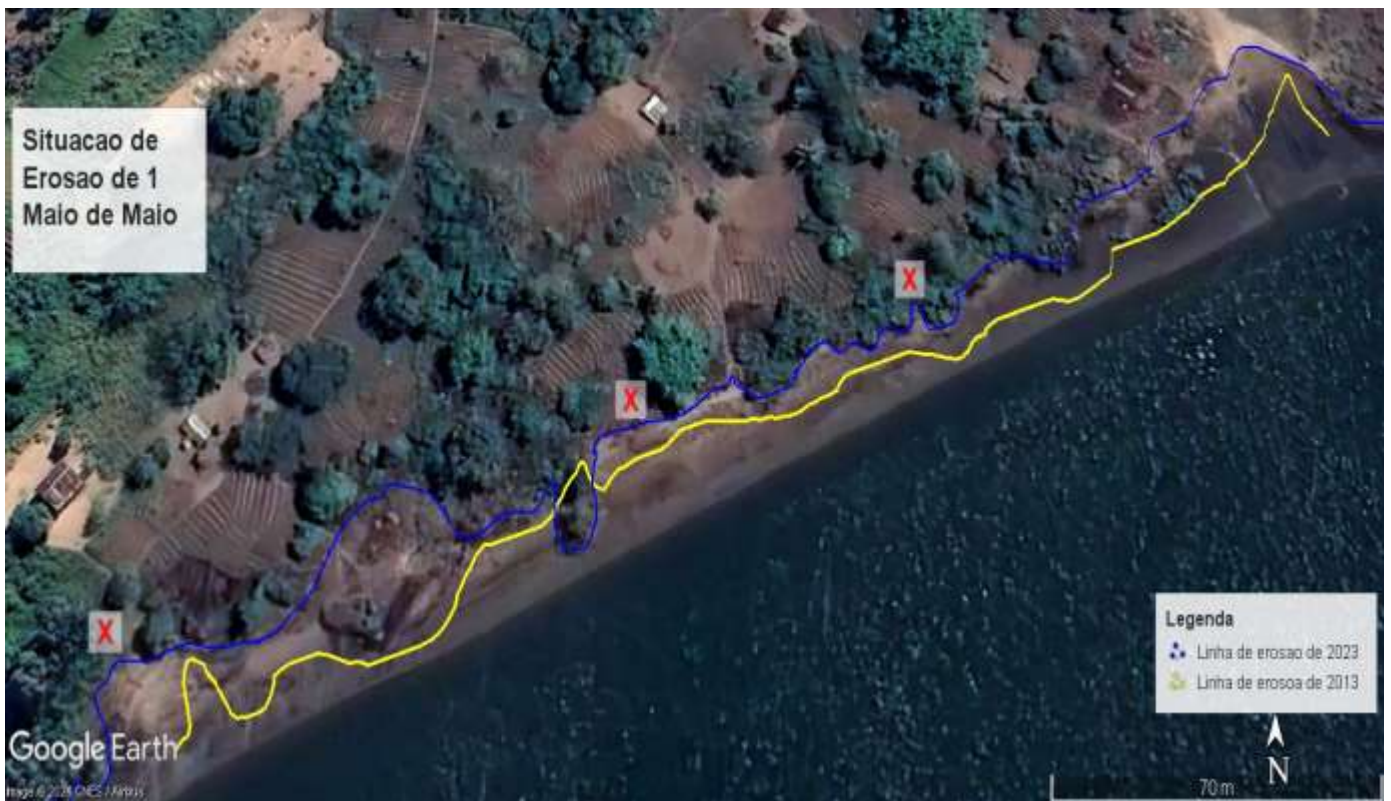
Figura 96. Situação da área depois do processo erosivo
