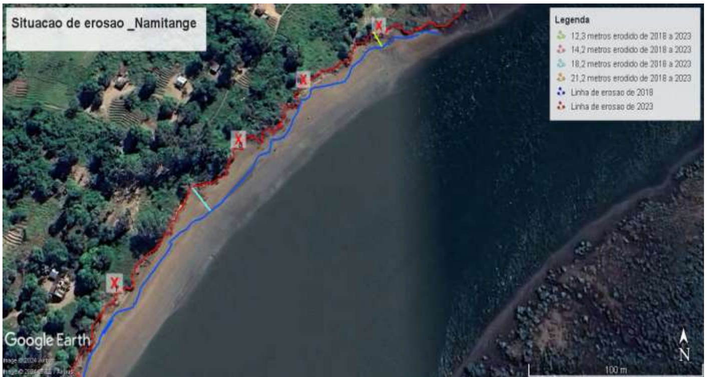
Figura 107. Situação de erosão de 2018 á 2023 na região de Namitange
