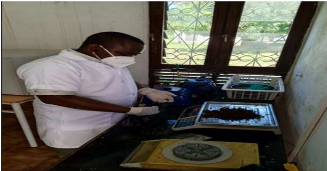
Figura 121. Medição de amostra de sedimento, antes do processo de remoção de humidade
