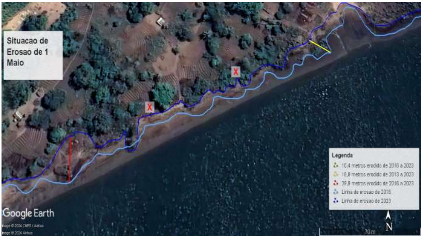
Figura 98. Situação de erosão de 2016 á 2023 na região do 1º de Maio
