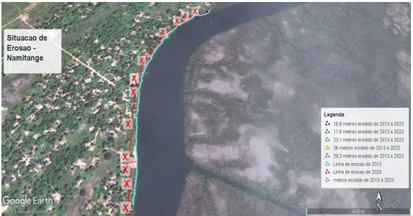
Figura 101. Situação de erosão de 2013 á 2023 na região de Namitange
