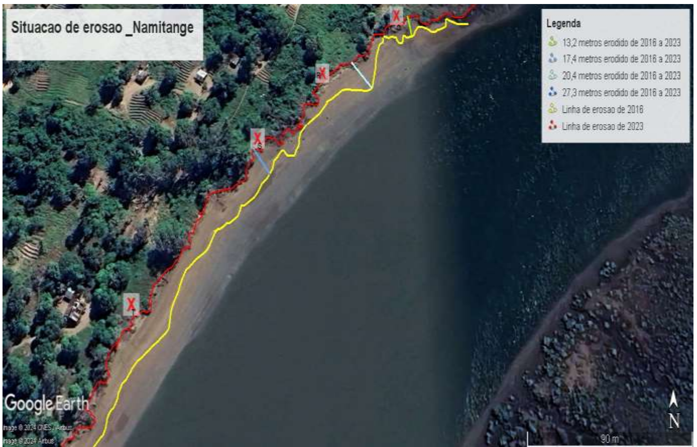
Figura 106. Situação de erosão de 2016 á 2023 na região de Namitange
