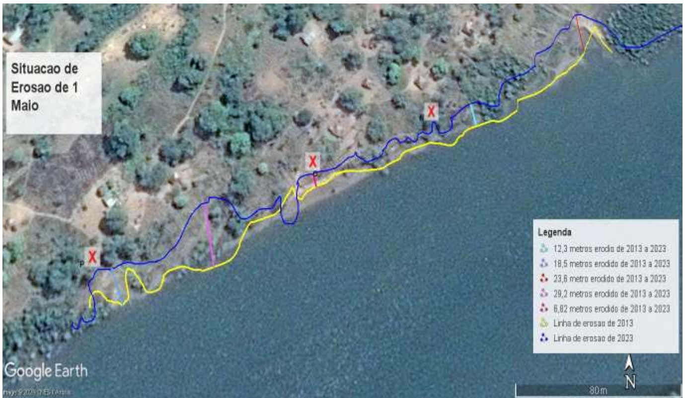
Figura 97. Situação de erosão de 2013 á 2023 na região do 1º de Maio
