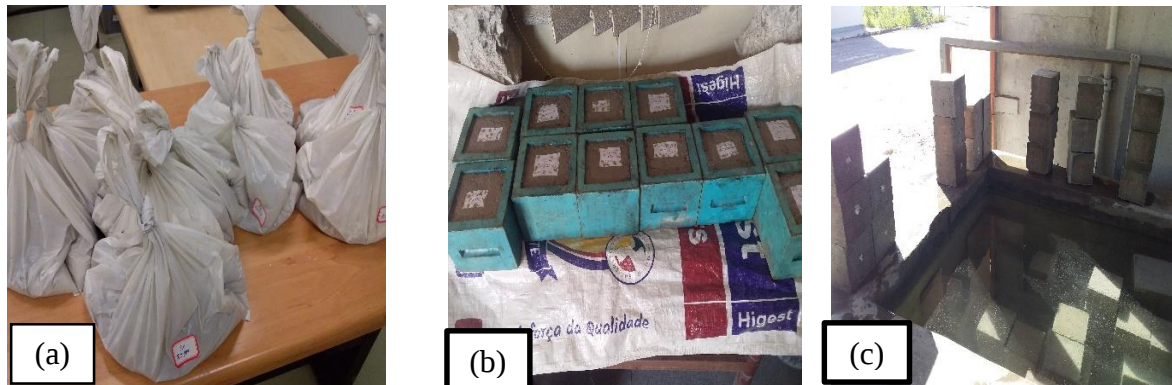
Figura 8: Moldagem dos provetes no laboratório da empresa Trans Aly: (a) sacos plásticos com a mistura, (b) moldagem dos provetes e (c) tanque de cura
