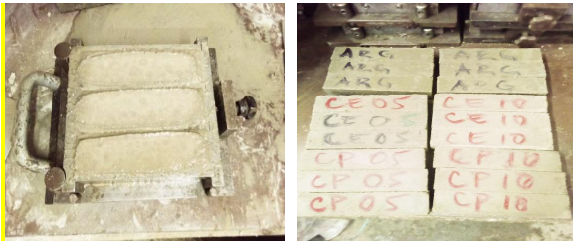
Figura 9: Moldagem dos provetes e depois da desmoldagem das argamassas
