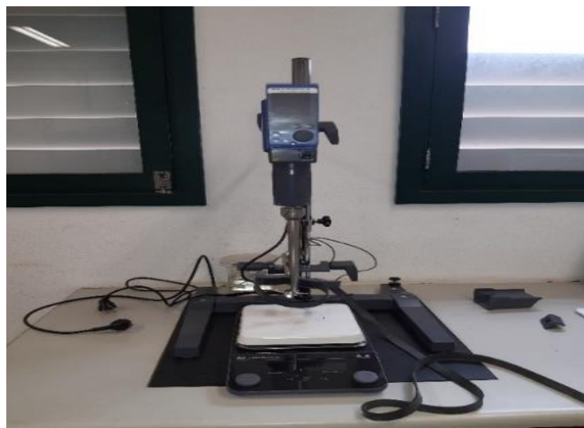
Figura 11. Misturador de alto cisalhamento IKA® EUROSTAR 20*.
