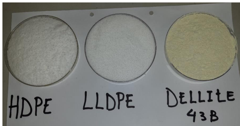
Figura 10. Aspecto físico dos modificadores. a) HDPE; b) LLDPE; c) Nanoargila Dellite 43B .
