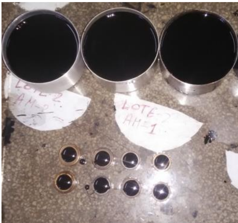
Figura 15. Amostras para o ensaio de anel e bola (ponto de amolecimento).
