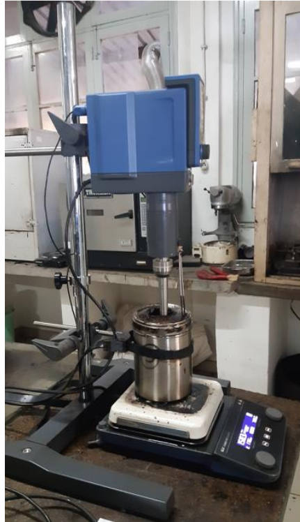
Figura 12. Preparação do asfalto modificado com HDPE e óleo vegetal de soja
